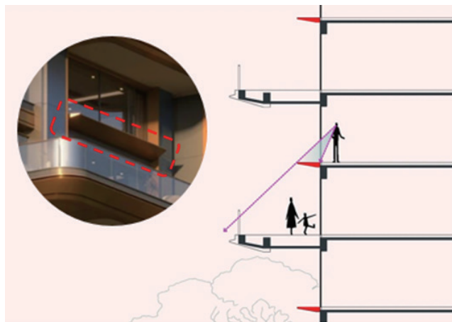
重庆观音桥千重锦项目，设置层间挑檐，规避上下层之间视线干扰
