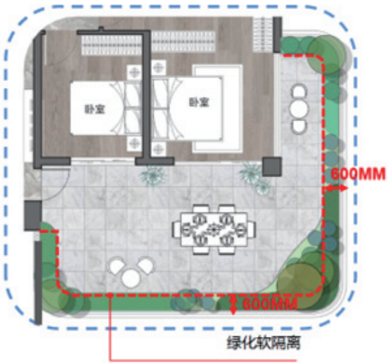
下沉式种植槽平面示意图
